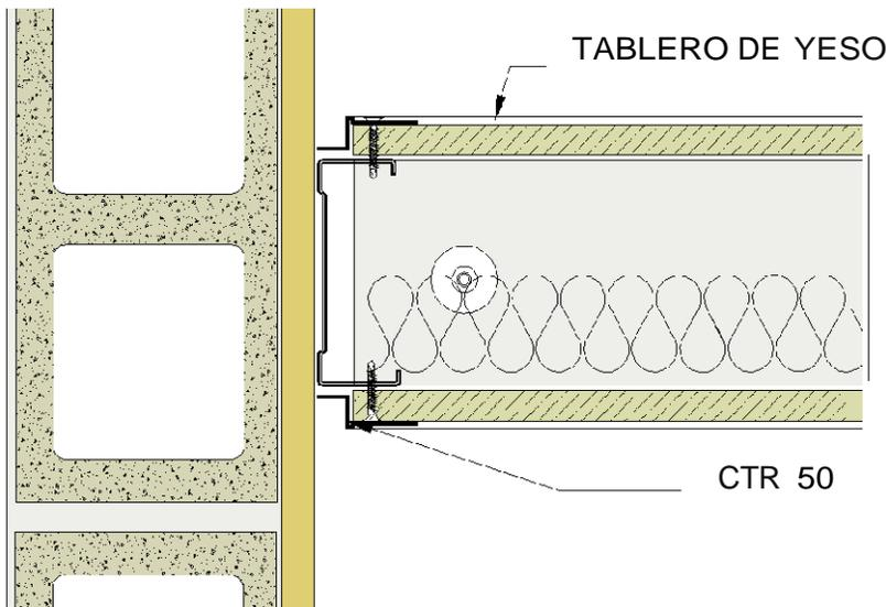
Remates de todo tipo con perfil CTR 50 se obtiene un perfilado limpio y perfecto sobre cualquier otro tipo de sistema o acabado.
