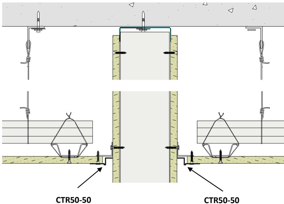
El uso del perfil CTR permite crear plafones de ultimo diseño y calidad a una velocidad impensable pues elimina el fastidio del crear la "buña" u los elementos que con ella conllevan, pues el delineado, limpieza y pintado de la buña se eliminan en un solo paso con el perfil CTR 50
