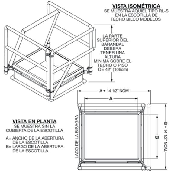
El sistema Bil-Guard®, es un sistema de barandales que brinda protección permanente cuando las escotillas se encuentran abiertas. Probado y comprobado para cumplir y superar las normas OSHA (29 CFR 1910.23), el sistema Bil-Guard tiene un innovador sistema de fijación el cual no requiere de perforaciones en el techo, se instala rápida y fácilmente utilizando herramientas básicas, y no requiere de ninguna capacitación especial o certificación para su correcta instalación.
