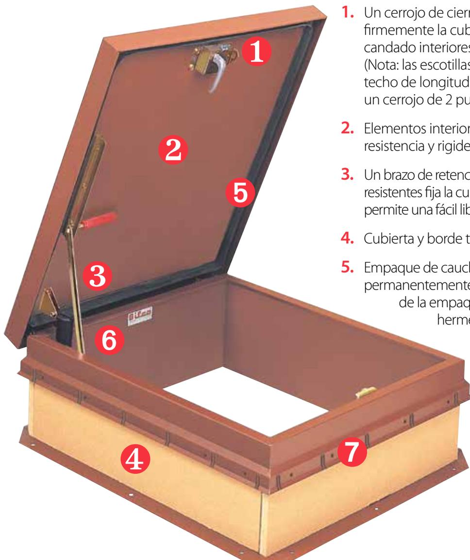
1. Un cerrojo de cierre por golpe reforzado permite asegurar firmemente la cubierta en la posición cerrada. Aldabas de candado interiores/exteriores brindan seguridad adicional. (Nota: las escotillas de techo de hoja doble y las escotillas de techo de longitud superior a 7,0 pies" (2,13m) cuentan con un cerrojo de 2 puntos.)
