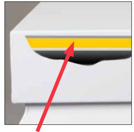
El elemento de baja conductividad integrado entre las superficies interior y exterior de la cubierta y del marco no sólo disminuye la transferencia de calor, sino que también amortigua la vibración, con lo cual se logra un mejor comportamiento acústico, mientras que el aislamiento de poliisocianurato de 3" brinda un valor de R = 18 que posibilita un rendimiento energético superior.
